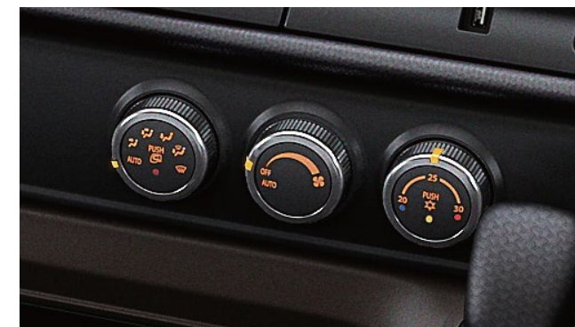
Kontrol pendingin udara
